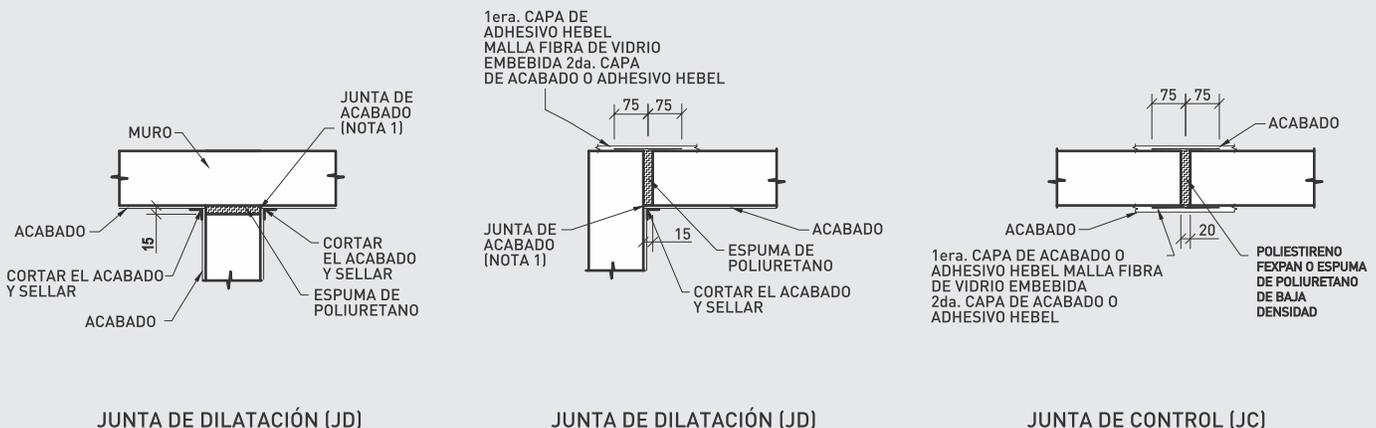
NOTA 1: ALTERNATIVAMENTE COLOCAR MALLA DE FIBRA DE VIDRIO EMBEBIDA EN ACABADO O ADHESIVO HEBEL.
